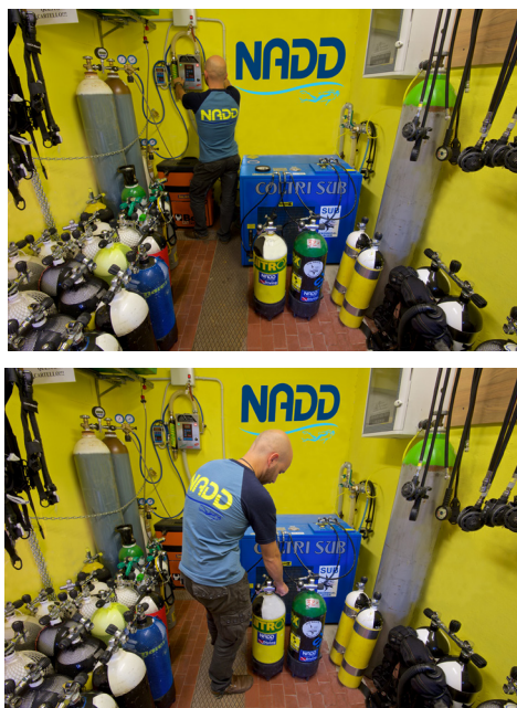
Stazione di ricarica Nitrox
